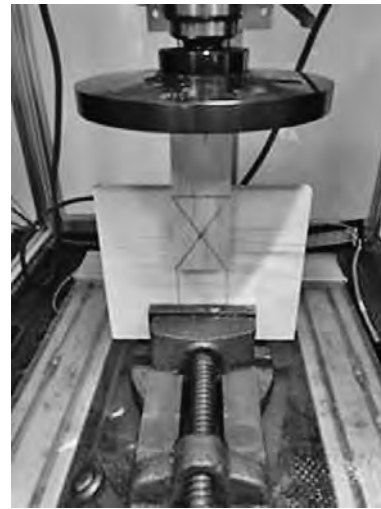
Figure 3 Static shear test for single staple Scotch pine joint Slika 3. Statički test na smicanje spoja s klamericom izrađenoga od borovine
