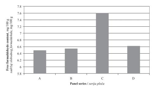
**Figure 1** Free formaldehyde content of experimentally produced particleboards **Slika 1.** Sadržaj slobodnog formaldehida ploča iverica izrađenih za eksperiment
