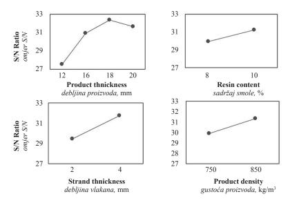
**Figure 5** Main effect plot of S/N ratio for compression strength parallel to grain **Slika 5.** Prikaz učinka omjera S/N na čvrstoću na tlak u smjeru vlakanaca
