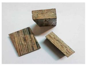
Figure 3 Examples of test specimens from date palm rachis-based LSL blocks Slika 3. Primjeri ispitnih uzoraka LSL blokova od lisnih osi palme datulje
