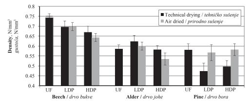
Figure 5 The average density values of test panels Slika 5. Srednje vrijednosti gustoće ispitivanih ploča
