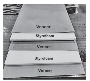
Figure 1 Structural design of three-layer polystyrene composite plywood panels Slika 1. Konstrukcijski izgled troslojne kompozitne uslojene ploče vezane polistirenom
