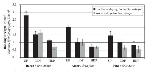
Figure 2 The average bonding strength values of test panels Slika 2. Srednje vrijednosti čvrstoće lijepljenog spoja ispitivanih ploča
