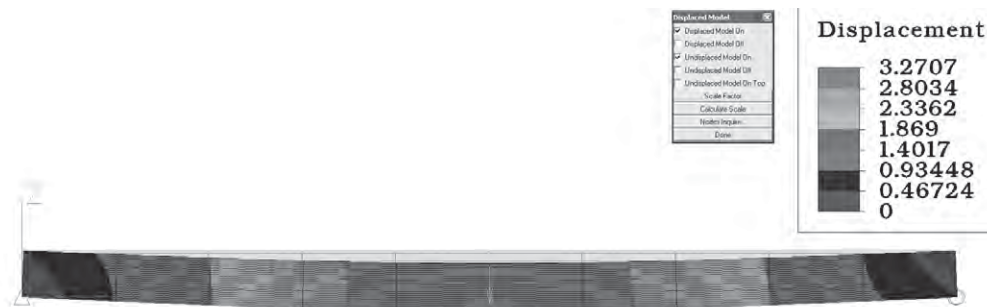
Figure 3 Values of vertical displacement (mm) in the model of plywood variant I Slika 3. Vrijednosti vertikalnog pomaka (mm) u modelu za furnirsku ploču varijante I.
