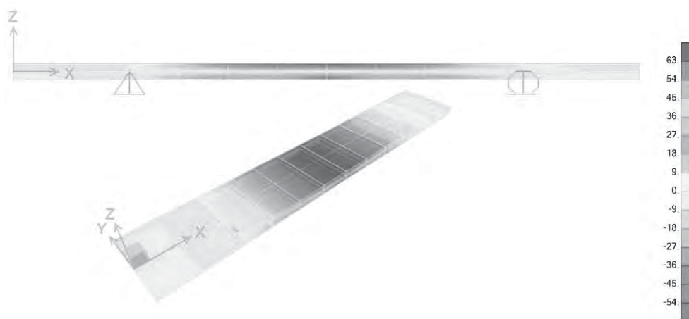
Figure 5 3D and 2D view of maximum principle stress contour diagrams (MPa) Slika 5. 3D i 2D prikaz najvećih kontura naprezanja (MPa)
