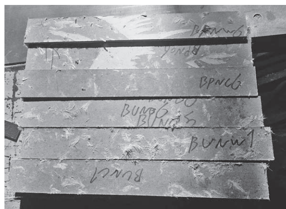
Figure 2 Surface of MOR specimens with feather content Slika 2. Površina uzoraka s perjem za određivanje modula loma
