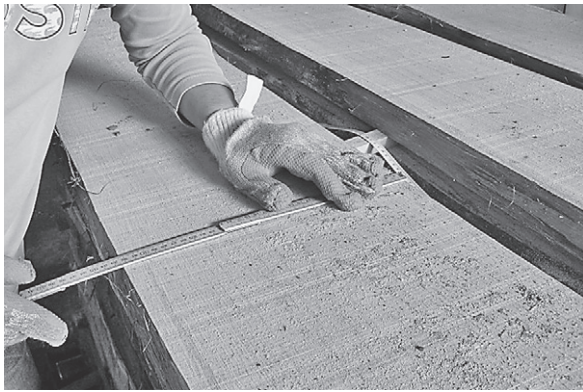
Slika 2. Ručno mjerenje neokrajčenih piljenica Figure 2 Manuel measuring of unedged sawn boards
