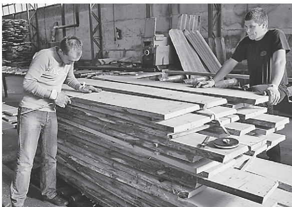
Slika 3. Preuzimanje i mjerenje neokrajčenih piljenica (samica) Figure 3 Handling and measuring of unedged sawn boards
