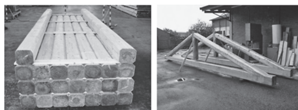
Figure 4 “Usò fiume” spruce beams (left) and trusses realized by assembling “Usò Fiume” larch beams (right) Slika 4. Smrekove grede Usò fiume (lijevo) i rešetka sastavljena od arišovih greda Usò fiume (desno)
