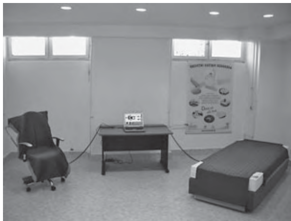
Laboratorij za ergonomiju – mjerne prostirke ErgoCheck Chair i Classic
