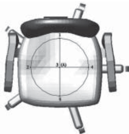
Slika 3. Tlocrtni prikaz položaja podloška i rasporeda točaka za mjerenje debljine ojaštucenja sjedala
