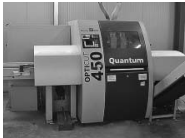
Slika 8. Detalj računalom upravljane kružne pile za poprečno piljenje drvnih elemenata optimiranjem duljina (PM Lignum)
