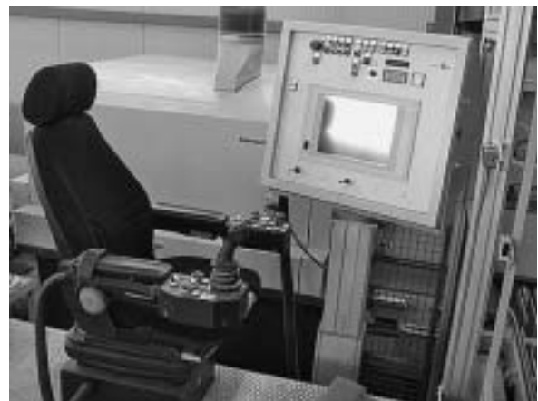
Slika 7. Detalj upravljačkoga radnog mjesta s računalnim sustavom za optimiranje položaja raspiljka na višelisnoj kružnoj pili (PM Lignum)
