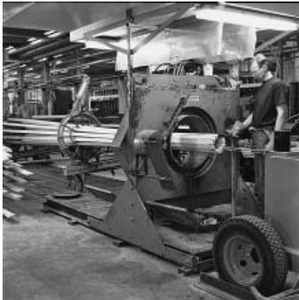
Figure 3 Body assembly and glue application Slika 3. Postupak slaganja i lijepljenja nosača
