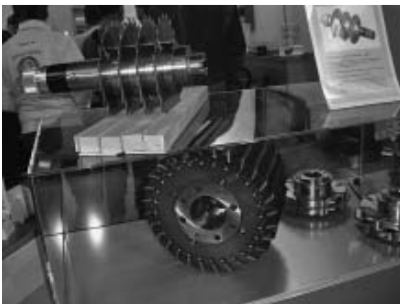
Glava s noževima za velike posmične brzine
