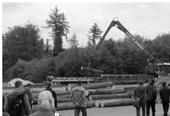
Duga se oblovinna dovozi kamionima, a razvrstavanje, krojenje i manipulacija obavlja se samovoznim kolicima i utovarivačem
