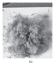
**Figure 1** a) Fine wood fibers (pine) used in face layers of MDF; b) Coarse wood fibers (beech) used in core layer of MDF **Slika 1**. a) Fina drvna vlakna (borovine) upotrijebljena u površinskom sloju MDF ploče; b) gruba drvna vlakna (bukovine) ugrađena u središnji sloj MDF ploče
