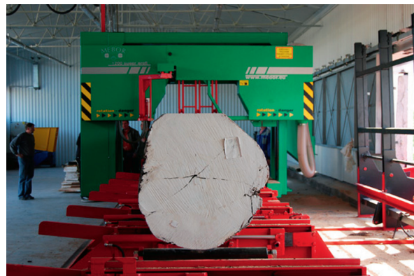
Figure 1 Horizontal log band saw Mebor HTŽ -1000 Slika 1. Horizontalna tračna pila trupčara Mebor HTŽ-1000
