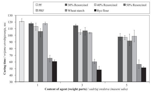
**Figure 2** Curing time of adhesive compositions **Slika 2**. Vrijeme otvrdnjavanja istraživanih smjesa za lijepljenje
