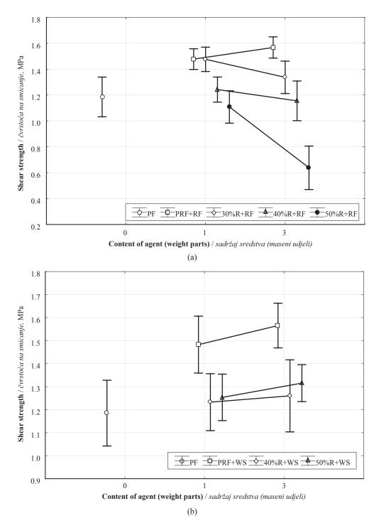
**Figure 6** Shear strength of plywood panels made using a mixture of modifying agents **Slika 6**. Čvrstoća na smicanje furnirskih ploča proizvedenih primjenom smjese sredstava za modificiranje ljepila
