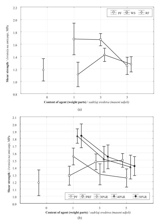
**Figure 3** Shear strength of plywood panels **Slika 3**. Čvrstoća furnirskih ploča na smicanje
