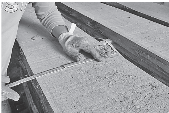
Slika 2. Ručno mjerenje neokrajčenih piljenica Figure 2 Manuel measuring of unedged boards
