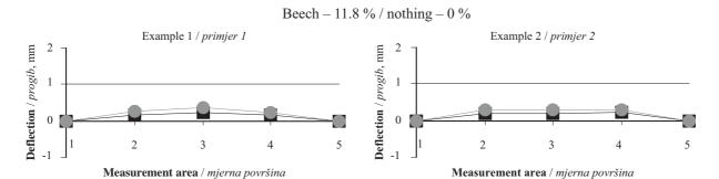
**Figure 4** Deflection of boards asymmetrically veneered on one large side – large difference of shrinkage values **Slika 4**. Progib ploča koje su asimetrično furnirane s obje strane - velika razlika između vrijednosti utezanja
