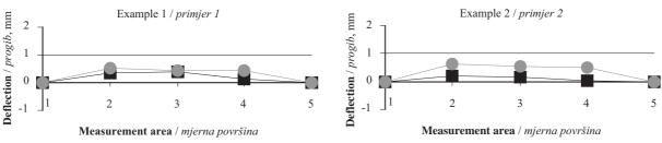
Figure 2 Deflection of the board asymmetrically veneered on both large sides - small difference of shrinkage values Slika 2. Progib ploče koja je asimetrično furnirana s obje strane - mala razlika između vrijednosti utezanja
