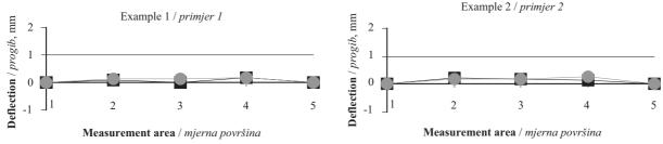
**Figure 3** Deflection of the board asymmetrically veneered on both large sides - significant difference of shrinkage values **Slika 3.** Progib ploče koja je asimetrično furnirana s obje strane - značajna razlika između vrijednosti utezanja
