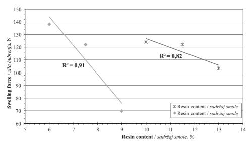
**Figure 5** Swelling force with regard to the layer resin content\*\* **Slika 5.** Sila bubrenja ovisno o sadržaju smole u pojedinom sloju
