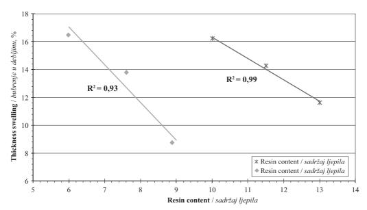
Figure 3 Thickness swelling with regard to the layer resin content\*\* Slika 3. Bubrenje u debljinu ovisno o sadržaju smole u pojedinom sloju
