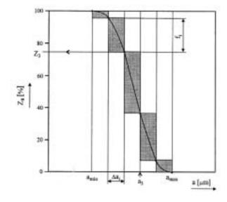
Figure 1 Curve of screen residue Za Slika 1. Krivulja raspodjele veličina čestica Za
