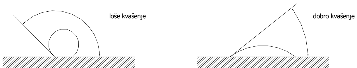
Slika 1. Ravnotežni oblik kapi i kut kvašenja Figure 1 Drop equilibrium shape and wetting angle
