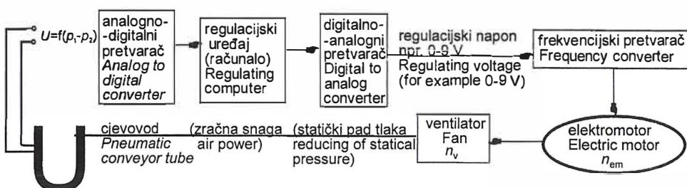
U-manometar ispunjen živom, s ugrađenim žičanim otpornikom, spojen s vodičem u strujni krug daje izlazni napon razmjeran promjeni tlaka.
