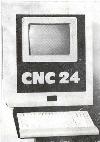
Sl. 2 — Weinig CNC-24, elektronički uređaj za upravljanje strojem za profiliranje, izveden sa 24 osovine, integriranim osobnim kompjutorom povezanim organizacijskim kompjutorom i učinkitim software-paketima
