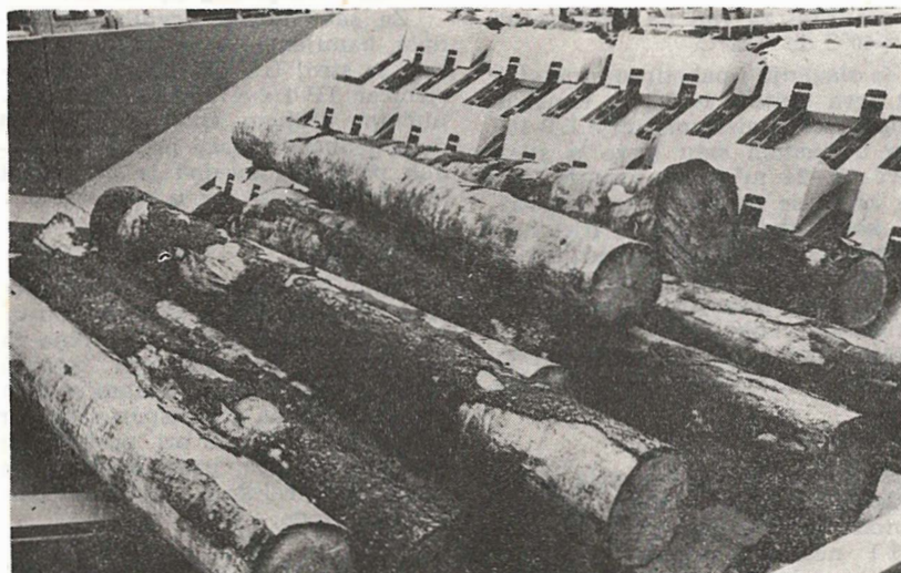
Slika 4. — Kaskadno doziralo pilanske oblovine LO-108
