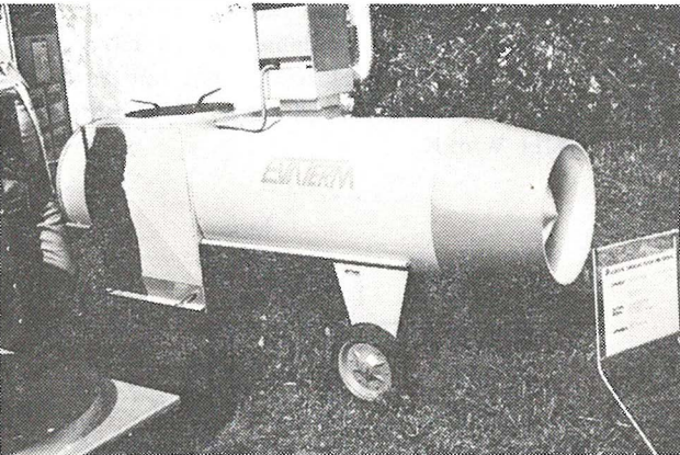
Slika 7 — Toplozračni agregat Evaterm, namijenjen za izgaranje drvnog otpada. (Pozemni stavby — Češke Budejovice).
