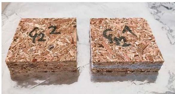
Figure 5 Internal bond strength test samples Slika 5. Uzorci za ispitivanje čvrstoće raslojavanja
