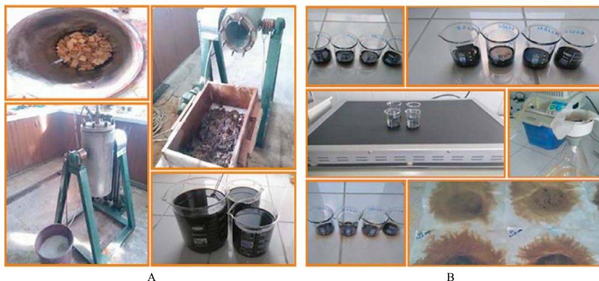
Figure 1 Obtaining (A) and recovery process (B) of lignin from black liquor Slika 1. Dobivanje (A) i proces izdvajanja (B) lignina iz crnog luga
