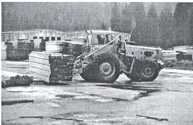
Slika 4. Utovarivač opremljen zahvatnom napravom za piljenu građu Figure 4. Loader with handling attachments for lumber
