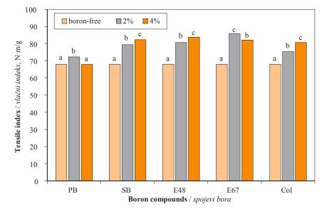
Figure 1 Effects of boron compounds on tensile index of pulps Slika 1. Utjecaj spojeva bora na vlačni indeks celuloze
