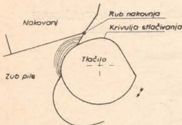
SLIKA 10 Okretanjem tlačila udesno potiskuje se materijal pile prema vrhu zuba
