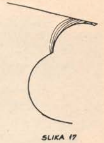
Slika 17. — Zub tlačen »mimo« nakovnjica«
