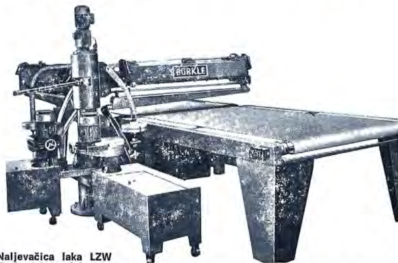
Naljevačica laka LZW Zaokretni uređaj za naljevanje. Brzo mijenjanje laka u 60 sek. Brzina protoka do 280 m/min.
