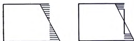
a) Prozračivanje kroz prozor katne visine i otvori za prozračivanje odozgo i odozdo vanjskog zida
