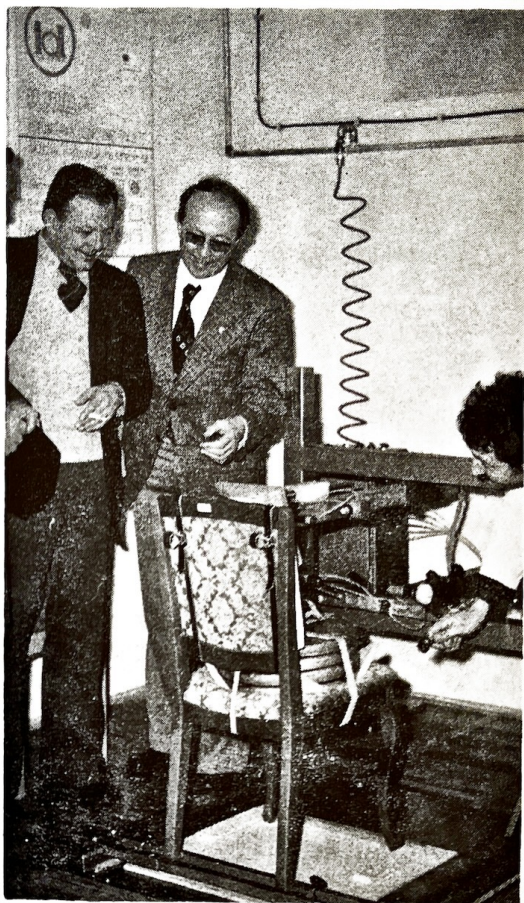
Demonstracija ispitivanja kvalitetnih osobina stolice u novootvorenom Laboratoriju Instituta za drvo (Foto A. Sorić)
