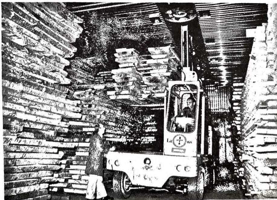
BOCNI VILIČAR PUNI KOMORE PILJENOM GRADOM OBOSTRANO U VENTILATORSKOM KORIDORU
