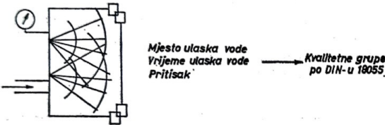
Sl. 4 — Shematski prikaz ispitivanja prozora na otpornost na udarnu kišu.
