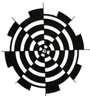
Slika 3. Sablon za centriranje upisanog valjka na čelu trupca.
