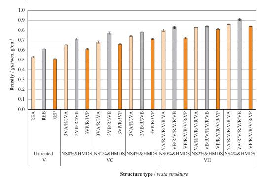
Figure 2 Density of composite plywood with different structures Slika 2. Gustoća kompozitne furnirske ploče s različitim strukturama
