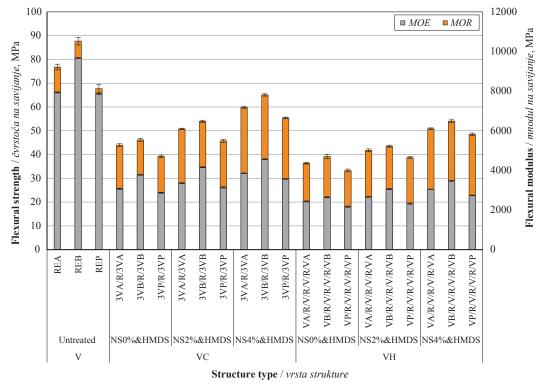
**Figure 5** Flexural modulus and flexural strength of composite plywood with different structures **Slika 5.** Modul elastičnosti pri savijanju i čvrstoća na savijanje kompozitne furnirske ploče s različitim strukturama
