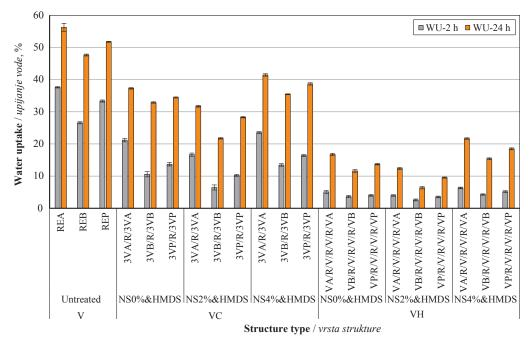
**Figure 3** Water uptake (%) of composite plywood with different structures **Slika 3.** Upijanje vode (%) kompozitne furnirske ploče s različitim strukturama
