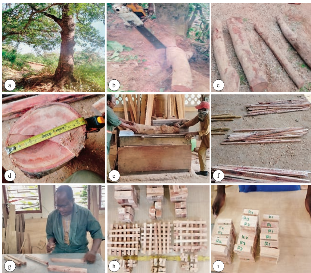
Figure 1 Root wood samples preparation for physical and mechanical tests Slika 1. Priprema uzoraka drva korijena za ispitivanje fizičkih i mehaničkih svojstava
