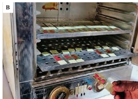
B) Slides kept in an oven to dry B) Sušenje predmetnih stakalaca u sušioniku
